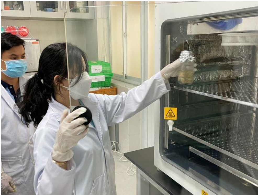
Đưa mẫu lúa có chứa nấm Aspergillus flavus vào máy tạo CO2 trong phòng thí nghiệm. Ảnh: Hà An
