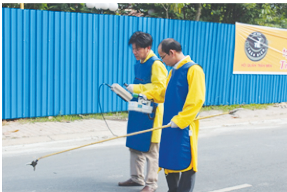
Hình 6: Đội ứng phó sự cố thực hiện đo liều phóng xạ, dò tìm nguồn và xử lý nguồn đảm bảo an toàn bức xạ hạt nhân
