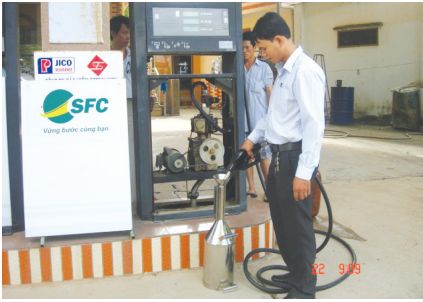
Kiểm tra sai số đo lường đối với trụ bơm
