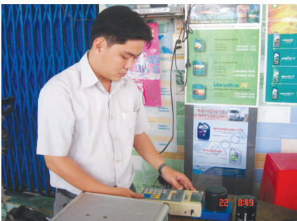
Kiểm tra nhanh chất lượng xăng bằng máy đo nhanh trị số Octan
