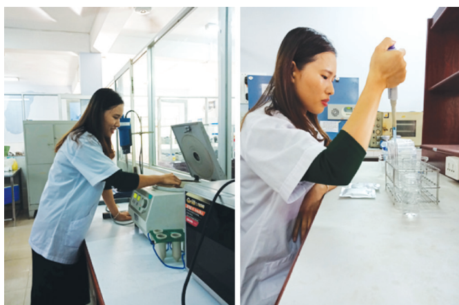
Hình 1, 2: Thạc sỹ Nguyễn Thị Ngọc Mai đang ly tâm để thu hồi dịch chiết polyphenol từ hạt thanh long và xác định hàm lượng polyphenol tổng trong hạt thanh long
