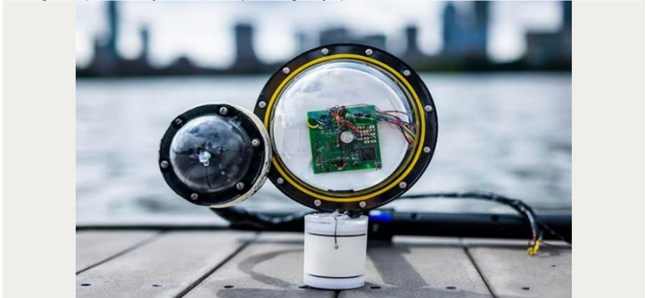
Thiết kế camera truyền ảnh không dây dưới nước của MIT. Ảnh: MIT
