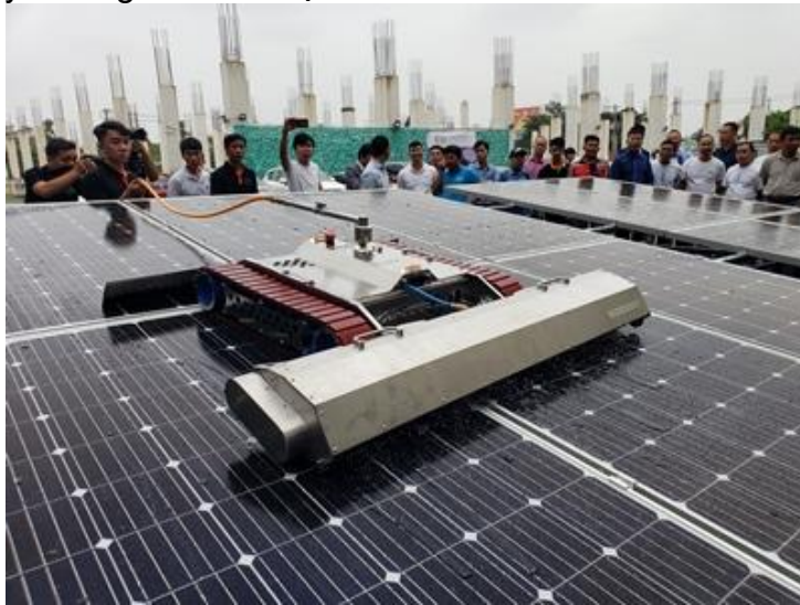
Robot vệ sinh pin năng lượng mặt trời trình diễn để khách hàng lựa chọn.
