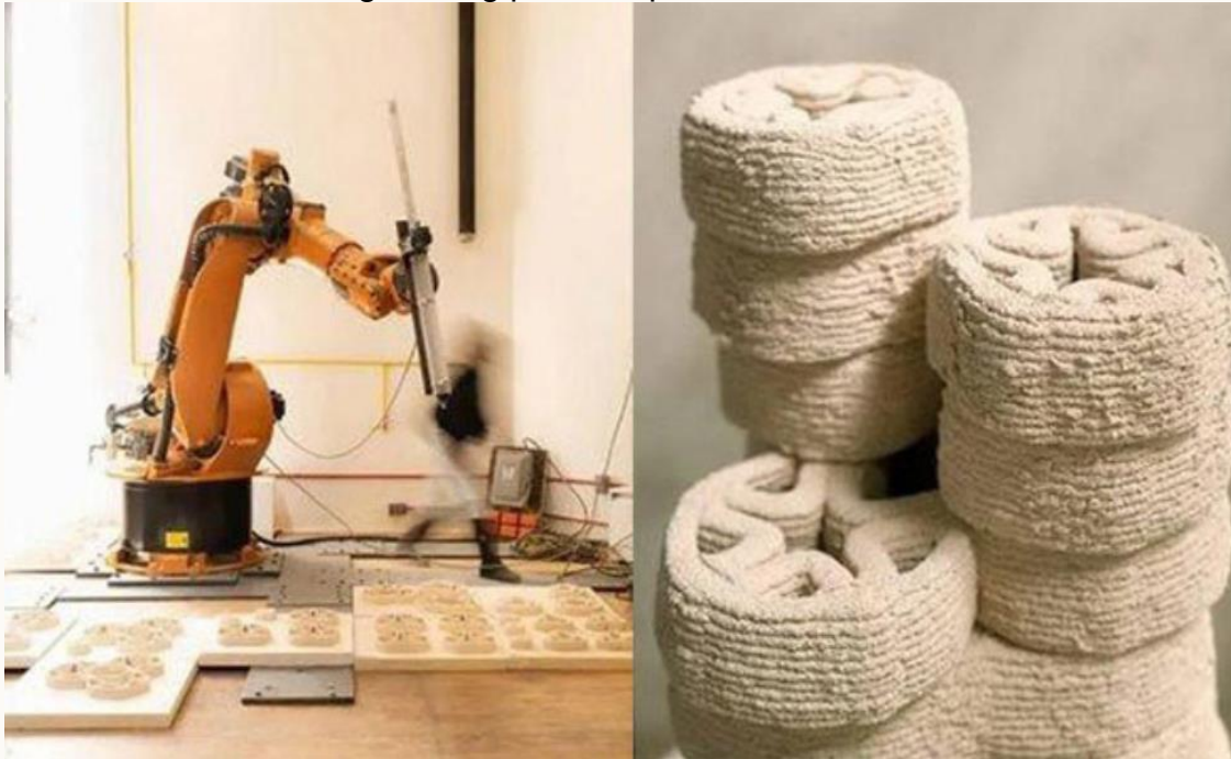
Gạch in 3D từ vỏ trứng - Ảnh: Manufactura
