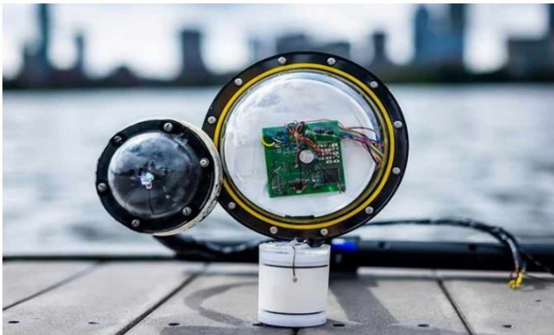
Thiết kế camera truyền ảnh không dây dưới nước của MIT. Ảnh: MIT
