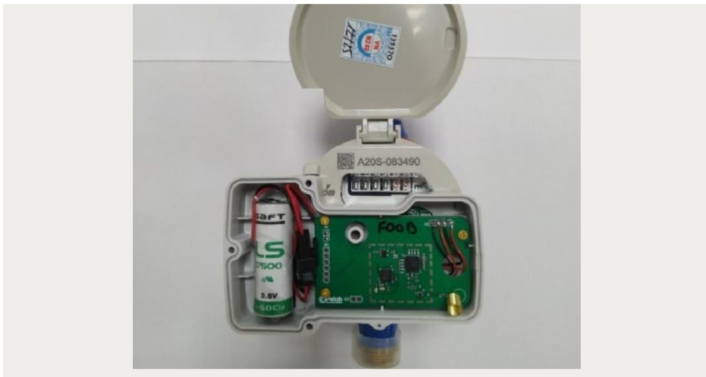
Hình ảnh thiết bị gắn vào mặt đồng hồ nước cơ. Ảnh: NVCC
