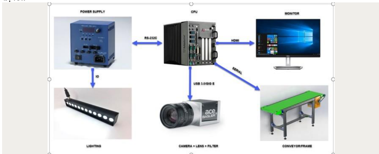
Sơ đồ các thiết bị phần cứng của hệ thống. Ảnh: NVCC
