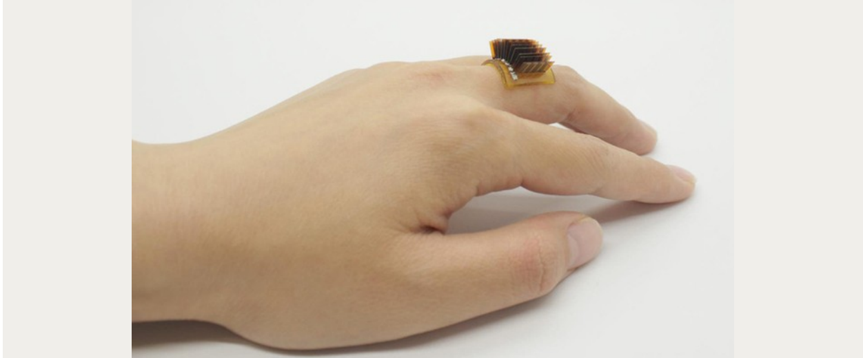
Nhẫn nhiệt điện lấy năng lượng từ cơ thể người. Ảnh: Xiao Lab.
