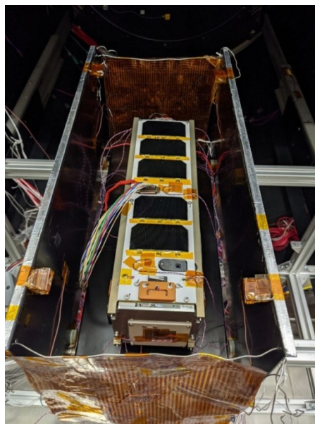
Vệ tinh Nanodragon trong thử nghiệm nhiệt chân không. Ảnh: VNSC.
