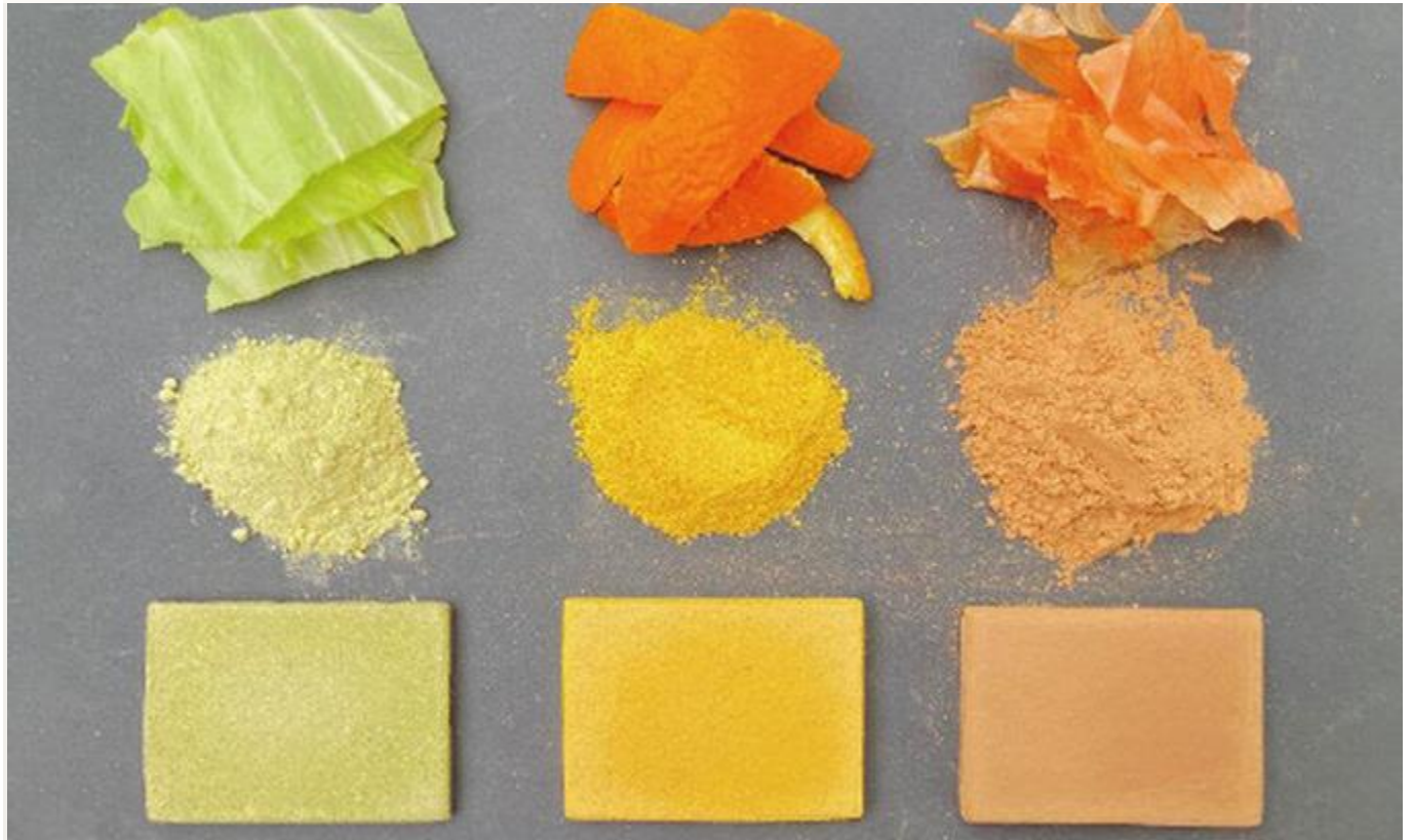
Các loại bột nghiền từ rác thải thực phẩm được ép thành vật liệu xây dựng. Ảnh: Đại học Tokyo.
