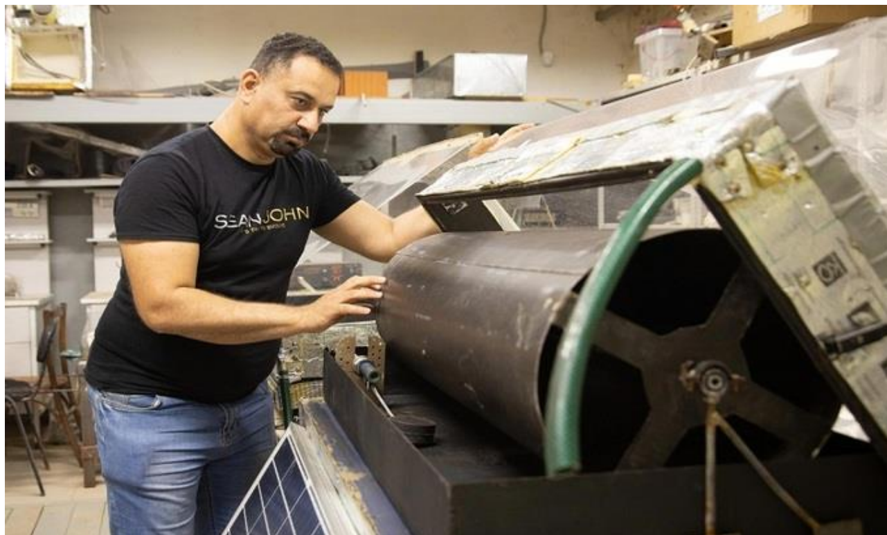
Kỹ sư Alharbawi Naseer Tawfiq Alwan lắp ráp nguyên mẫu máy chưng cất. Ảnh: UrFU/ Ilya Safarov.
