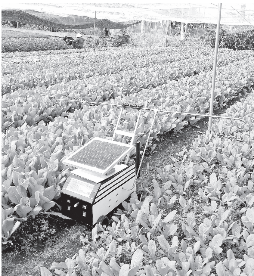
Xe phun thuốc trừ sâu điều khiển từ xa của nhóm tác giả
