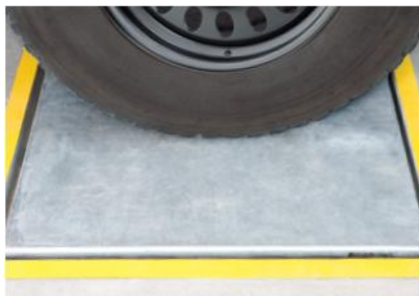
Hình 6. Thiết bị kiểm tra phanh của công ty Beissbarth (Đức)
