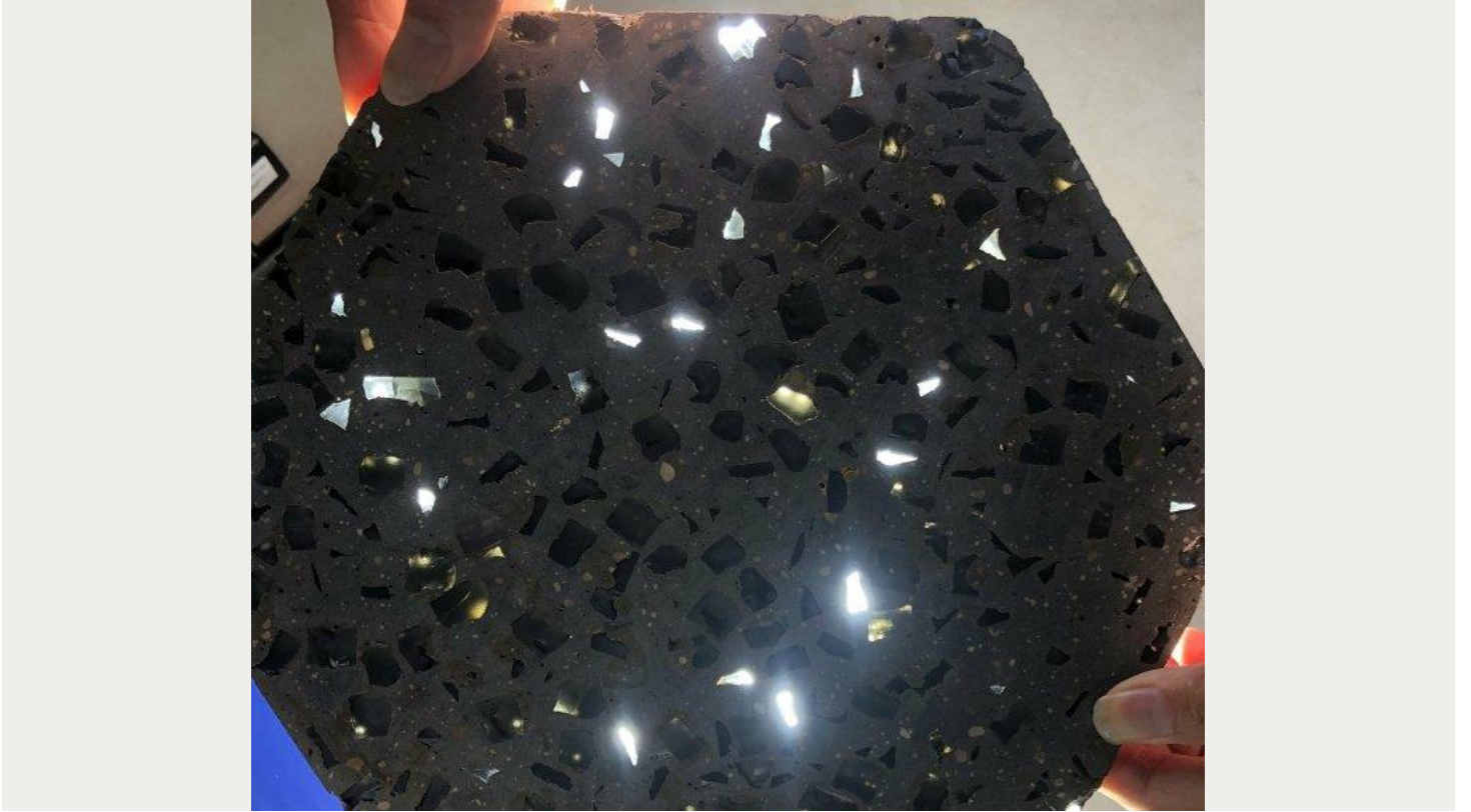
Tấm bê tông xanh truyền sáng được nhóm nghiên cứu chế tạo. Ảnh: Nhóm nghiên cứu
