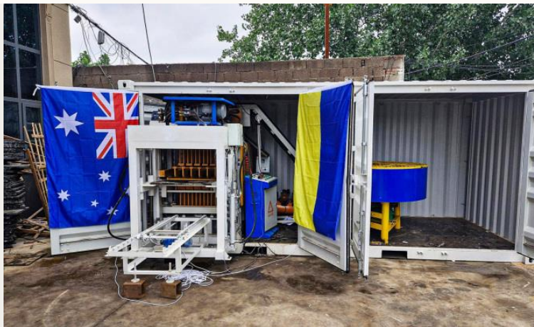
Nhà máy sản xuất gạch di động khá nhỏ gọn, đặt vừa trong container. Ảnh: MCC
