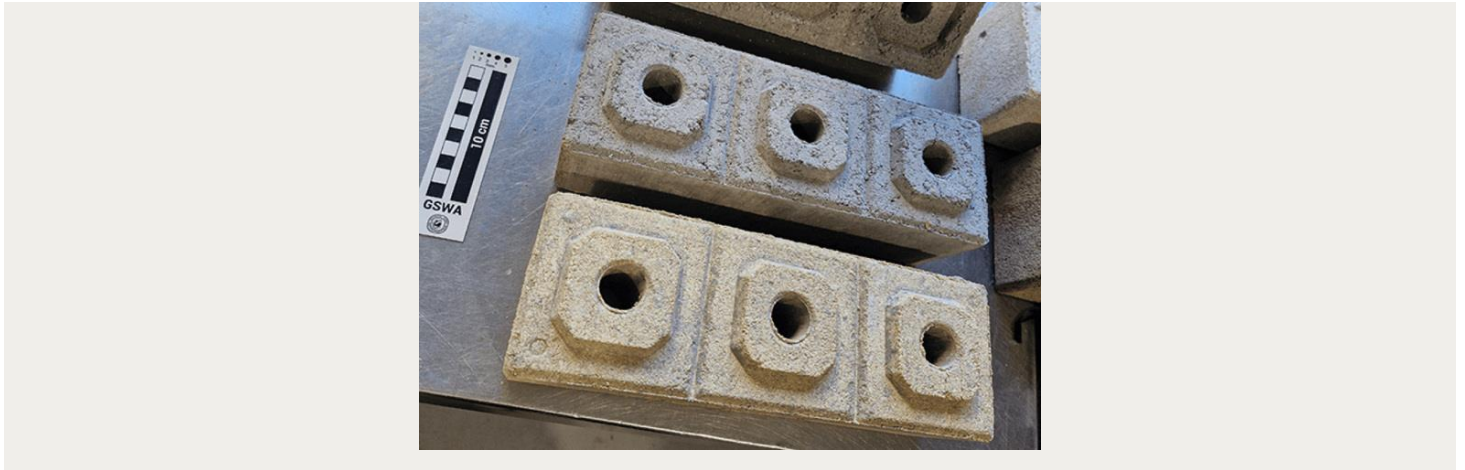
Gạch LayGo Block liên kết với nhau mà không cần vữa và có các lỗ để đặt thanh cốt thép. Ảnh: MCC
