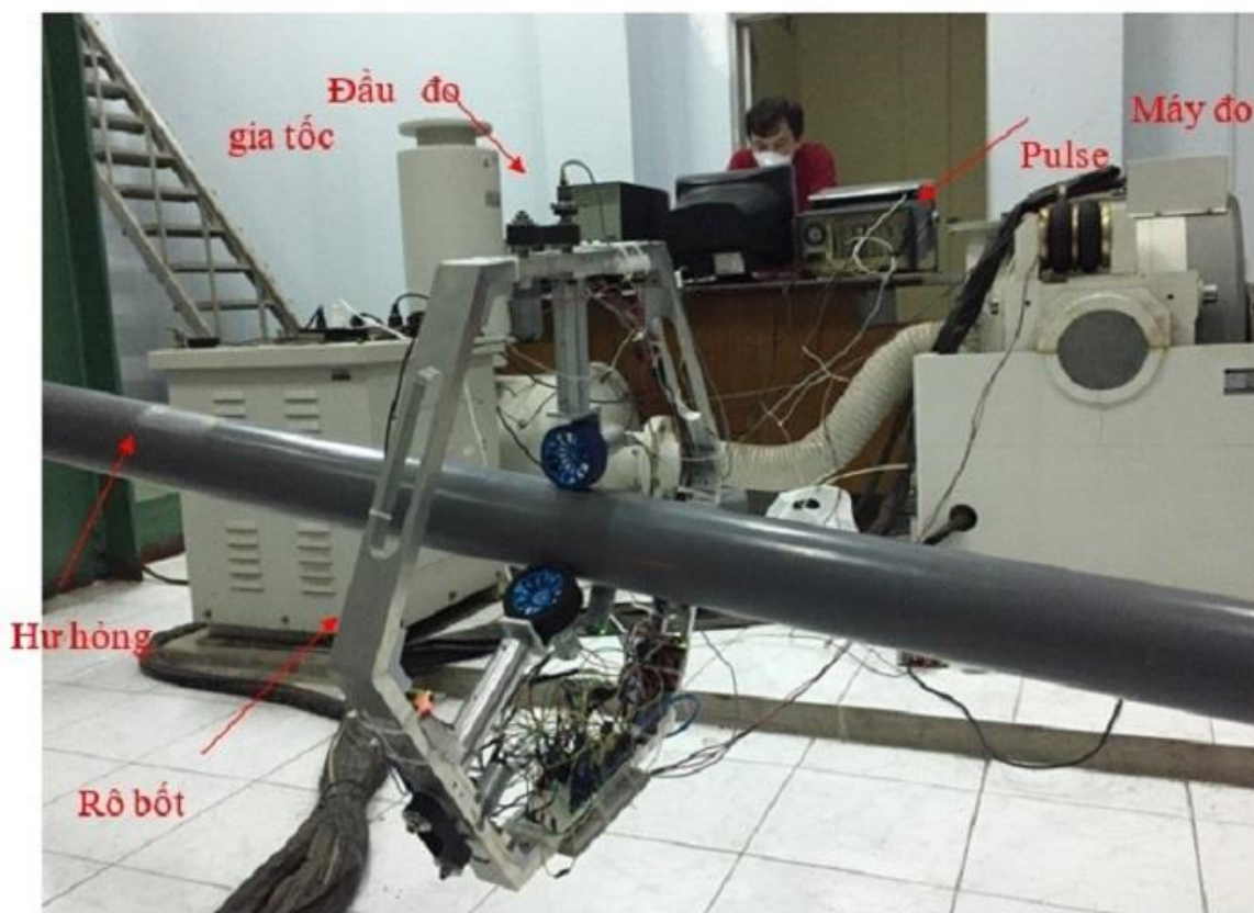
Rô bốt leo cáp và hệ thống đo dao động PULSE
