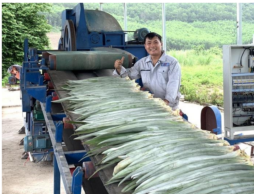
Tách xuất xơ thô từ lá dứa bằng dây chuyền tự động. Ảnh: TCBC
