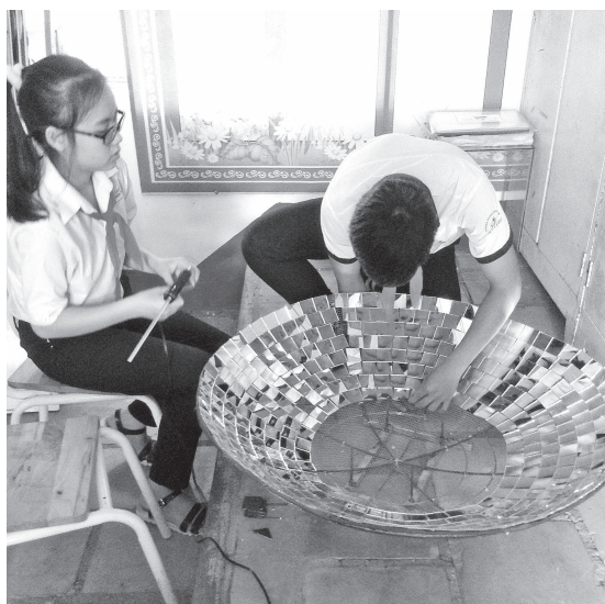
Hai bạn Duy và Hoàn đang lắp ráp máy sấy nông sản bằng gương cầu lõm.
