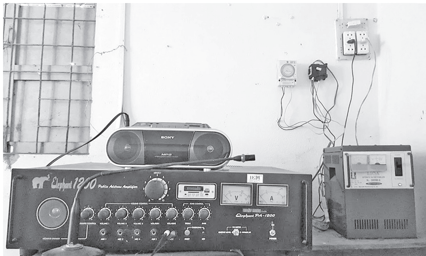
Ứng dụng hệ thống tự động bật/tắt đài truyền thanh tại xã Phú Xuân của anh Nguyễn Quang Long.
