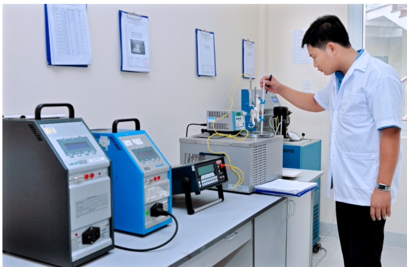
Thực hiện kiểm định hiệu chuẩn nhiệt tại Trung tâm Đo kiểm Nhơn Trạch.
