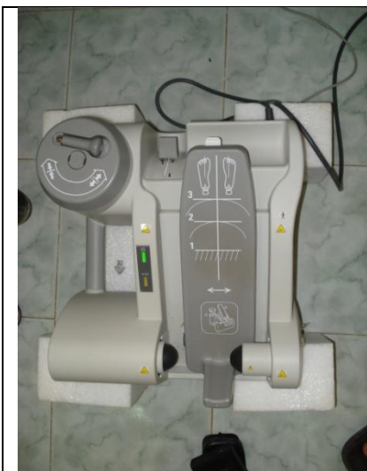
Hình 5. Kiểm tra công tắc điều khiển dạng bấm và giữ trước khi tiến hành chiếu X-quang
