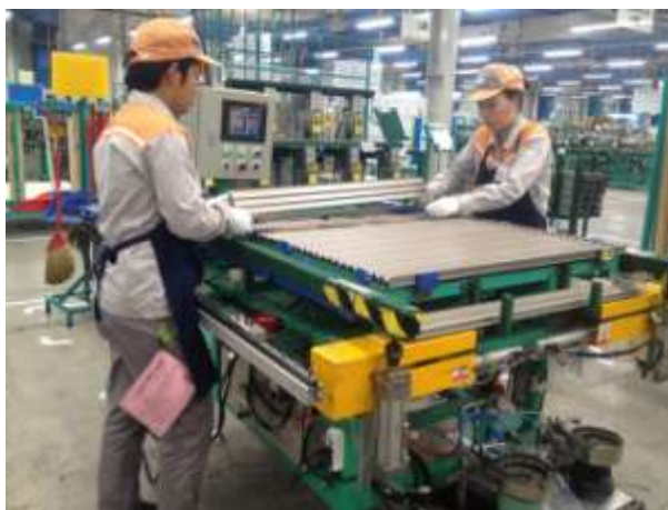
Máy bắt vít tự động ứng dụng sản xuất tại công ty Lixil Việt Nam
