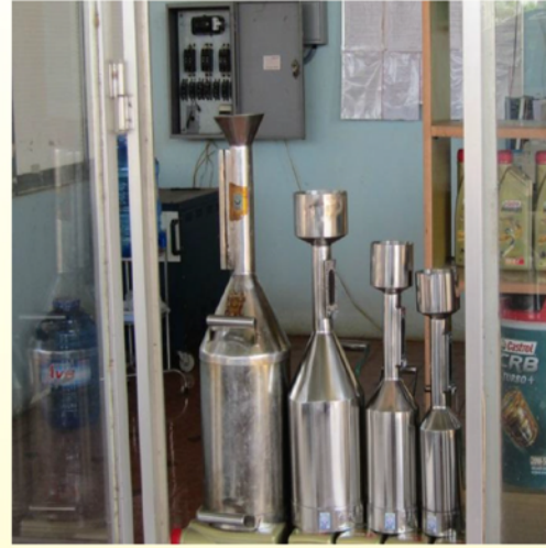
Bộ bình ca đong dùng để đối chứng cho người tiêu dùng, đặt vị trí thuận tiện cho việc kiểm tra
