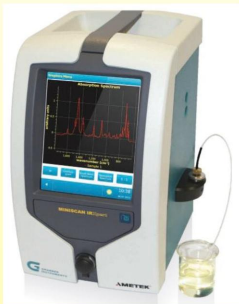
Thiết bị kiểm tra octane và cetane trong xăng và dầu
