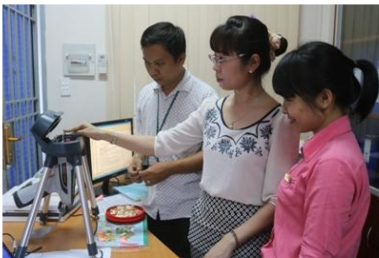
Máy đo hàm lượng vàng bằng công nghệ quang phổ di động
