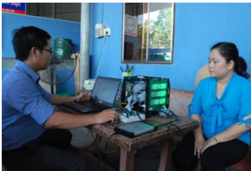
Cán bộ kỹ thuật Sở KH&CN hỗ trợ doanh nghiệp kiểm tra, hiệu chỉnh IC trong cột đo xăng, dầu
