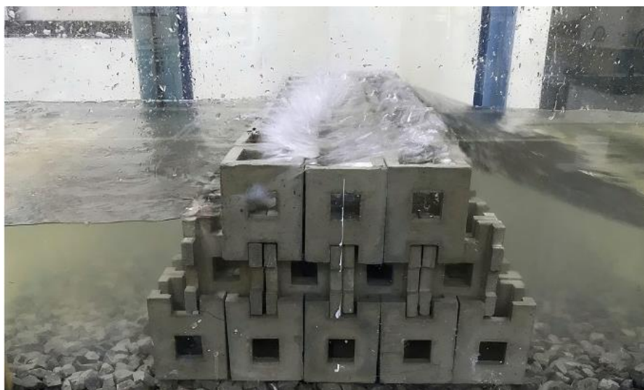
Thử nghiệm đê thấm trong phòng thí nghiệm. Ảnh: nhóm nghiên cứu
