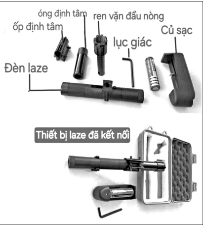
Các bộ phận kết nối đèn Laze hiệu chỉnh súng máy.
