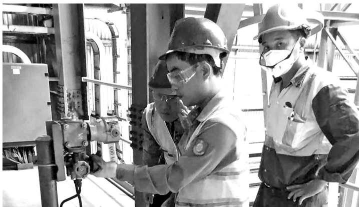
Cán bộ kỹ thuật Trung tâm Khoa học và Công nghệ Đồng Nai thực hiện hiệu chuẩn các thiết bị chuyển đổi áp suất.
