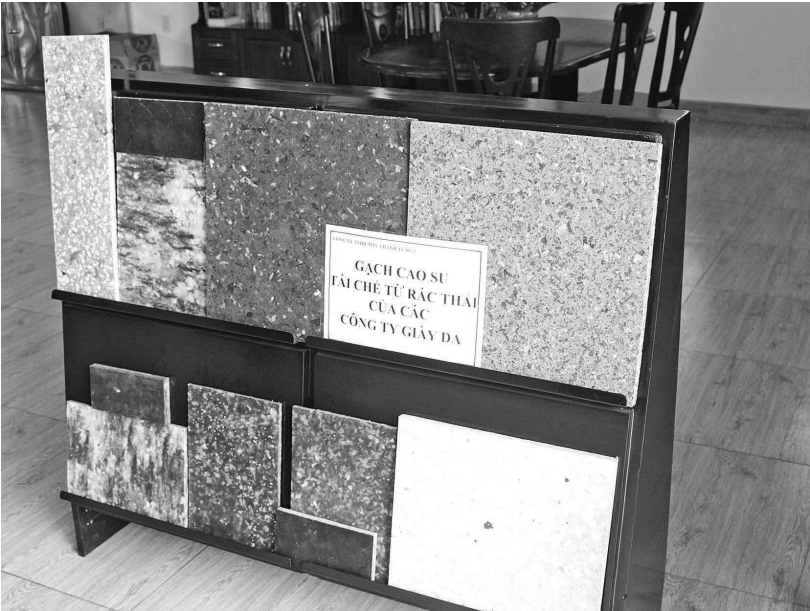
Sản phẩm gạch tái chế từ chất thải công nghiệp của Công ty TNHH MTV Thanh Tùng 2.
